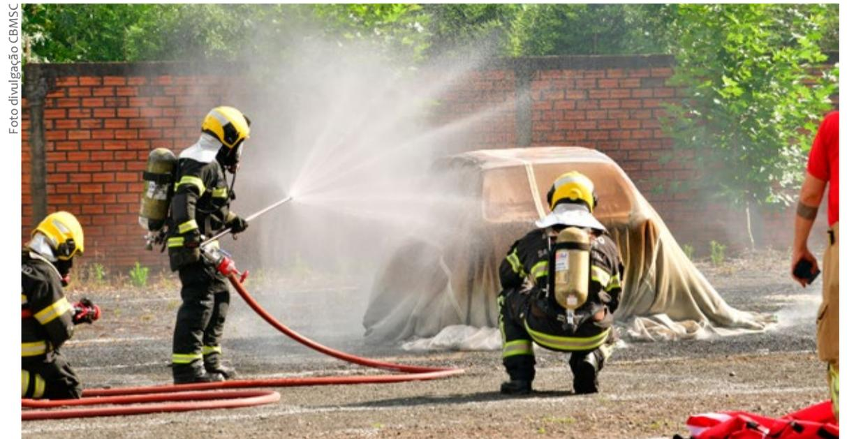
MANTA TÉRMICA é uma das opções para conter os incêndios originados de veículos elétricos por ser feita com material tecnológico
