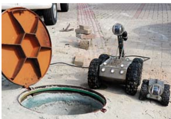
O uso de robôs permite acessar as tubulações e confirmar irregularidades por videoinspeção
